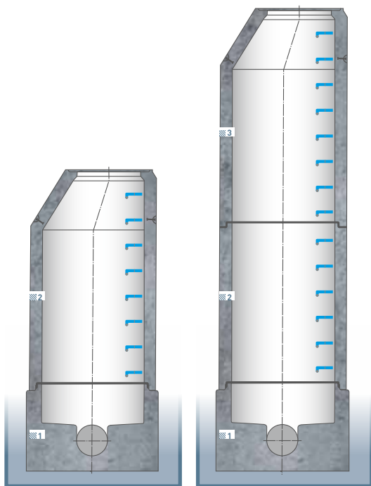
⌘ 1 Schachtbodenteil „Perfect“ ⌘ 2 „EXACT-Schacht“ Bauhöhen 850 mm - 2350 mm
