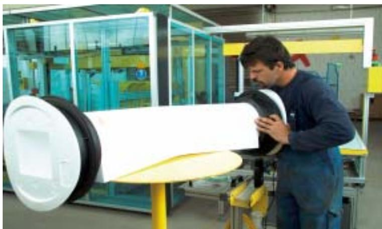
Zuletzt werden die Negativformen mit den Anschlußkörpern verklebt, die bereits die später in den gegossenen Schacht integrierten Dichtungen tragen.
