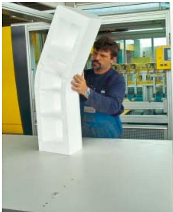
Mujo Zhabollaj, bei Beton-Heller der Spezialist für Schachtbodenteile, verklebt die zugeschnitten Teile zur Gerinneform. Per Laserstrahl gleicht der Computer die Form mit der Konstruktionsvorlage ab, um einen passenden Zuschnitt zu gewährleisten.
