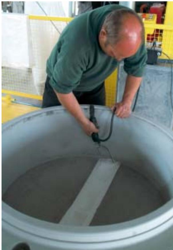
Betonbauer aus Leidenschaft: Helmut Heller entfernt die Styropor-Formen aus dem Schacht und verlädt die ausgehärteten Betonteile höchstpersönlich zum Versand.
